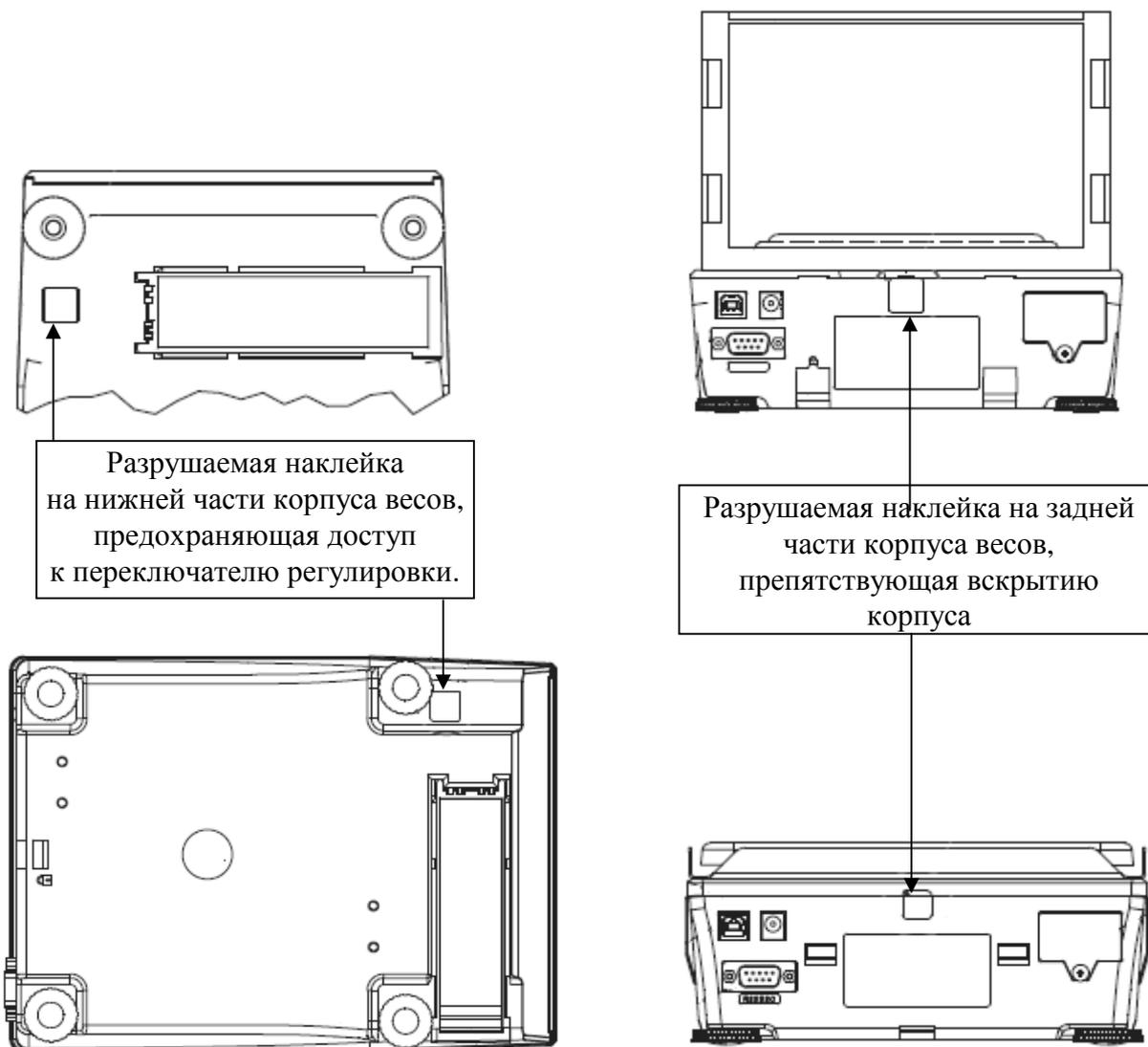
Рисунок 2 - Схема пломбировки весов от несанкционированного доступа
