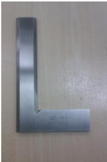
Рисунок 1 – Угольник поверочный 90° лекальный плоский типа УЛП.
