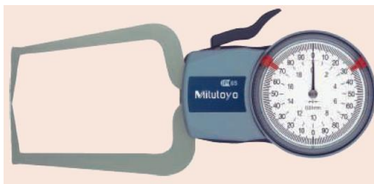
Рисунок 2 - Общий вид калибров-скоб серии 209 с отсчетом по круговой шкале для измерений наружных размеров
