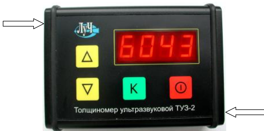
Рисунок 1 - Общий вид толщиномеров ТУЗ-2 и места нанесения пломбировки.
