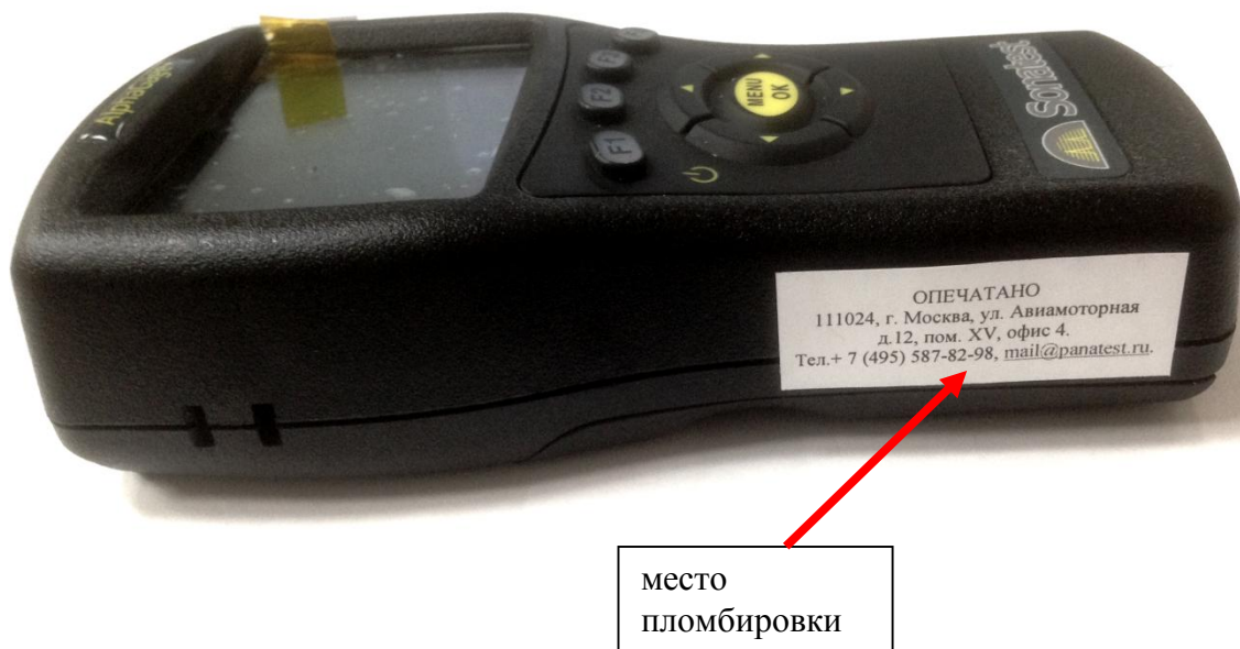
Рисунок 2 – Схема пломбировки от несанкционированного доступа
