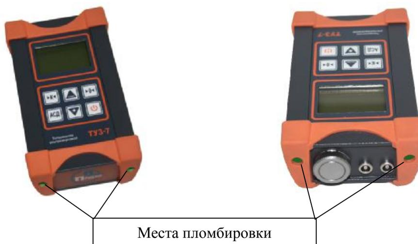
Рисунок 2 - Схема пломбировки от несанкционированного доступа
