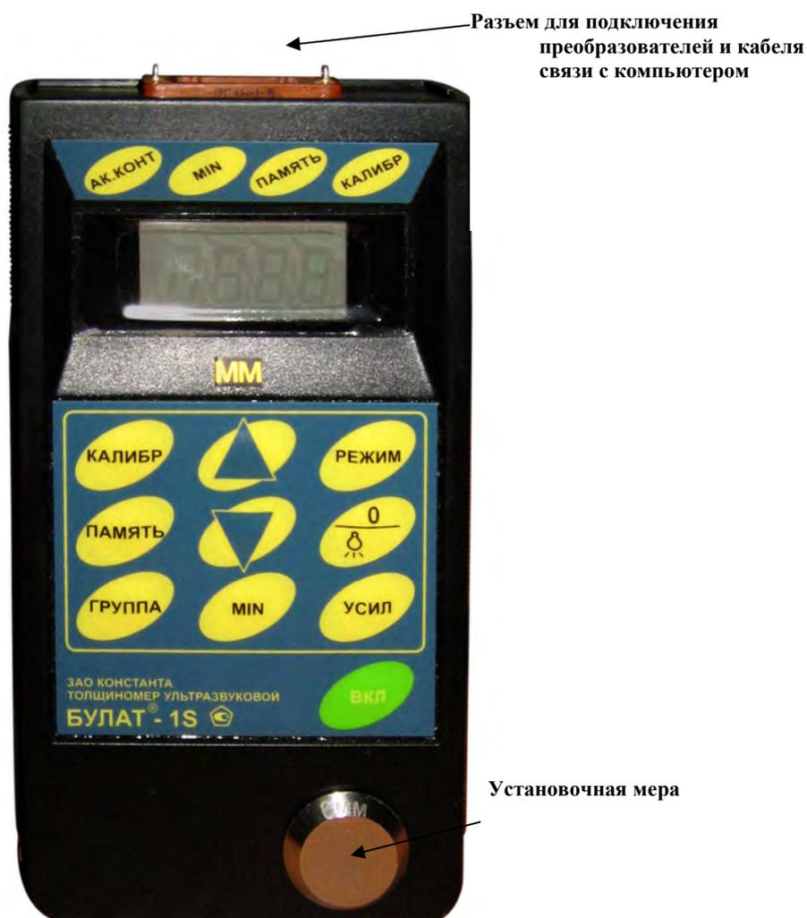
Рисунок 1. Блок обработки информации
