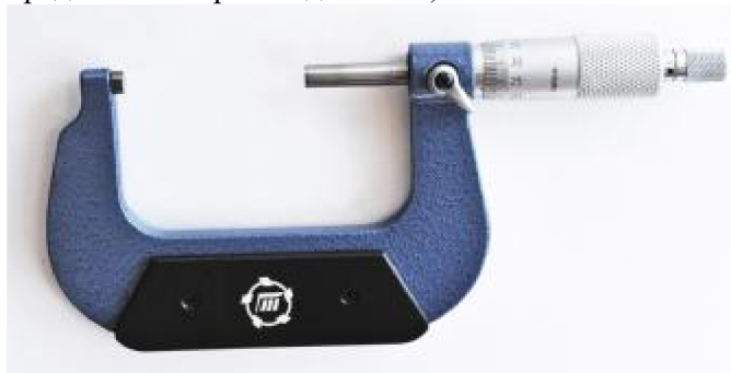
Рисунок 1 - Общий вид микрометров гладких типа МК с отсчетом показаний по шкалам стебля и барабана.
