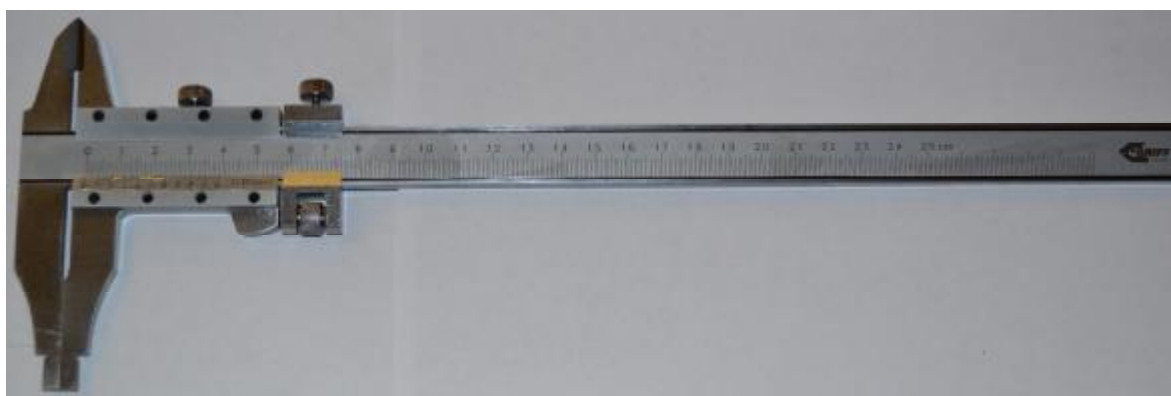
Рисунок 3 – Общий вид штангенциркулей с отсчетом по нониусу двусторонних без глубиномера.
