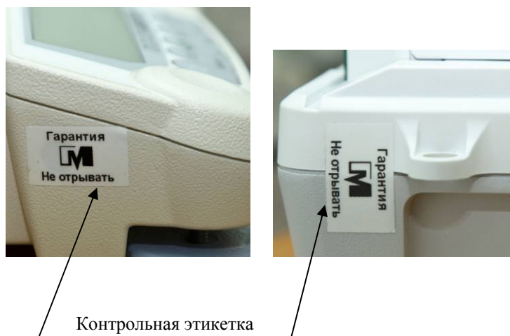
Рисунок 2 - Схема пломбирования от несанкционированного доступа
