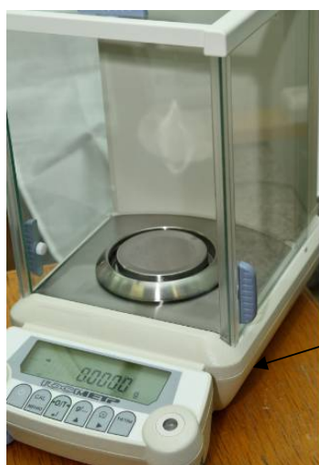
Рисунок 3 - Обозначение места нанесения знака поверки весов
