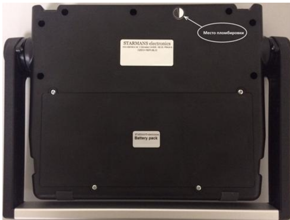
Рисунок 2 - Схема пломбировки от несанкционированного доступа
